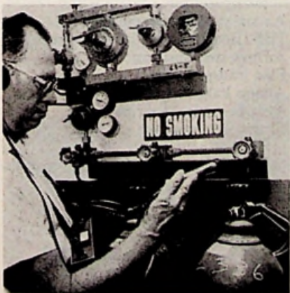
Een lekkende condensor wordt binnen een half uur opgespoord. Dit lek kan zowel in de koptelefoon als op een indicatiemeter worden waargenomen.
